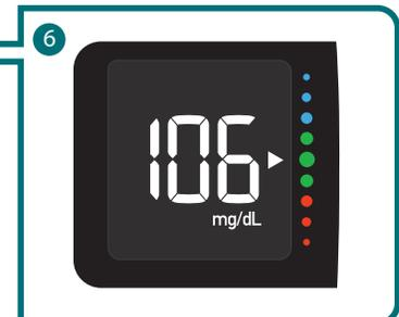
6 El resultado de medición aparece en la pantalla en menos de 4 segundos y la flecha indica si su resultado se encuentra por encima, dentro o por debajo del rango deseado.
