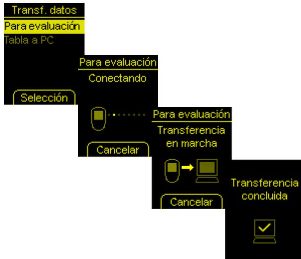
El medidor de glucemia Accu-Chek Mobile (modelo U8) dispone de una interfaz de infrarrojos incorporada para la transferencia de datos. Para leer datos de estos dispositivos, debe proceder de la manera siguiente:
