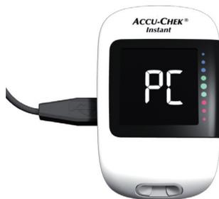
El medidor de glucemia Accu-Chek Instant dispone de una interfaz USB incorporada para la transferencia de datos.
