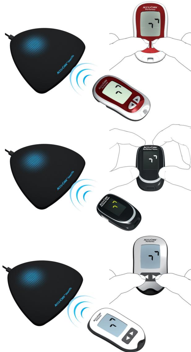
Los medidores de glucemia Accu-Chek Performa y Accu-Chek Performa Nano disponen de una interfaz de infrarrojos incorporada para la transferencia de datos. Para leer datos de estos dispositivos, debe proceder de la manera siguiente:
