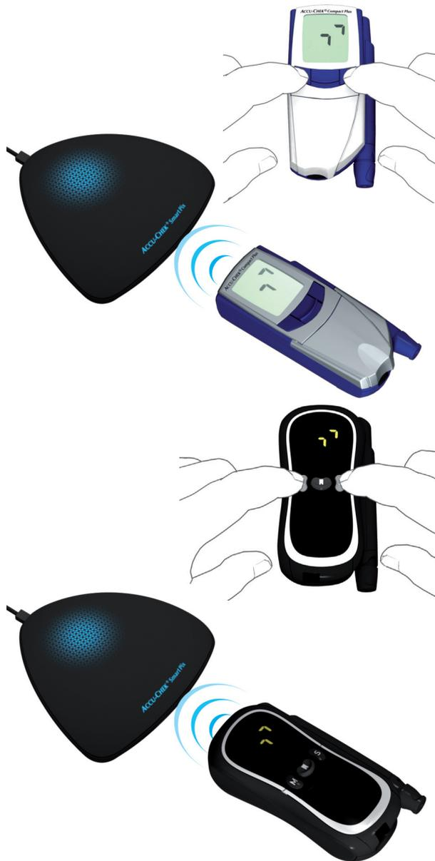
El medidor de glucemia Accu-Chek Compact Plus dispone de una interfaz de infrarrojos incorporada para la transferencia de datos. Para leer datos de estos dispositivos, debe proceder de la manera siguiente:
