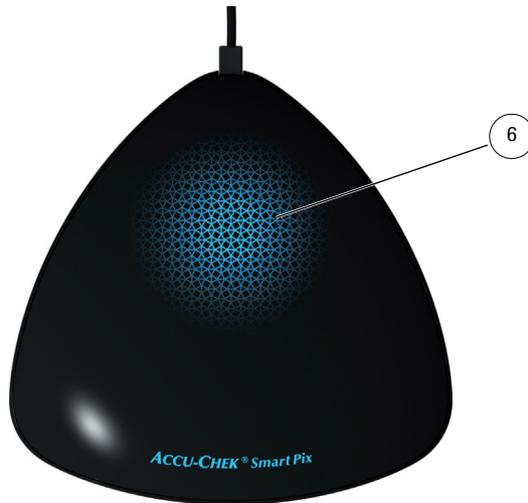
El sistema Accu-Chek Smart Pix señala posibles errores (p. ej. durante la transferencia de datos) mediante la intermitencia rápida de la superficie luminosa central **6**.
